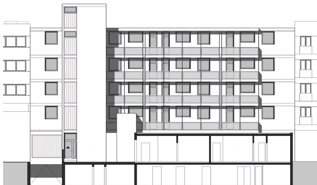
ANSICHT RÜCKSEITE LAUBENGÄNGE / AUBENFLURE MIT WOHNUNGSEINGÄNGEN
